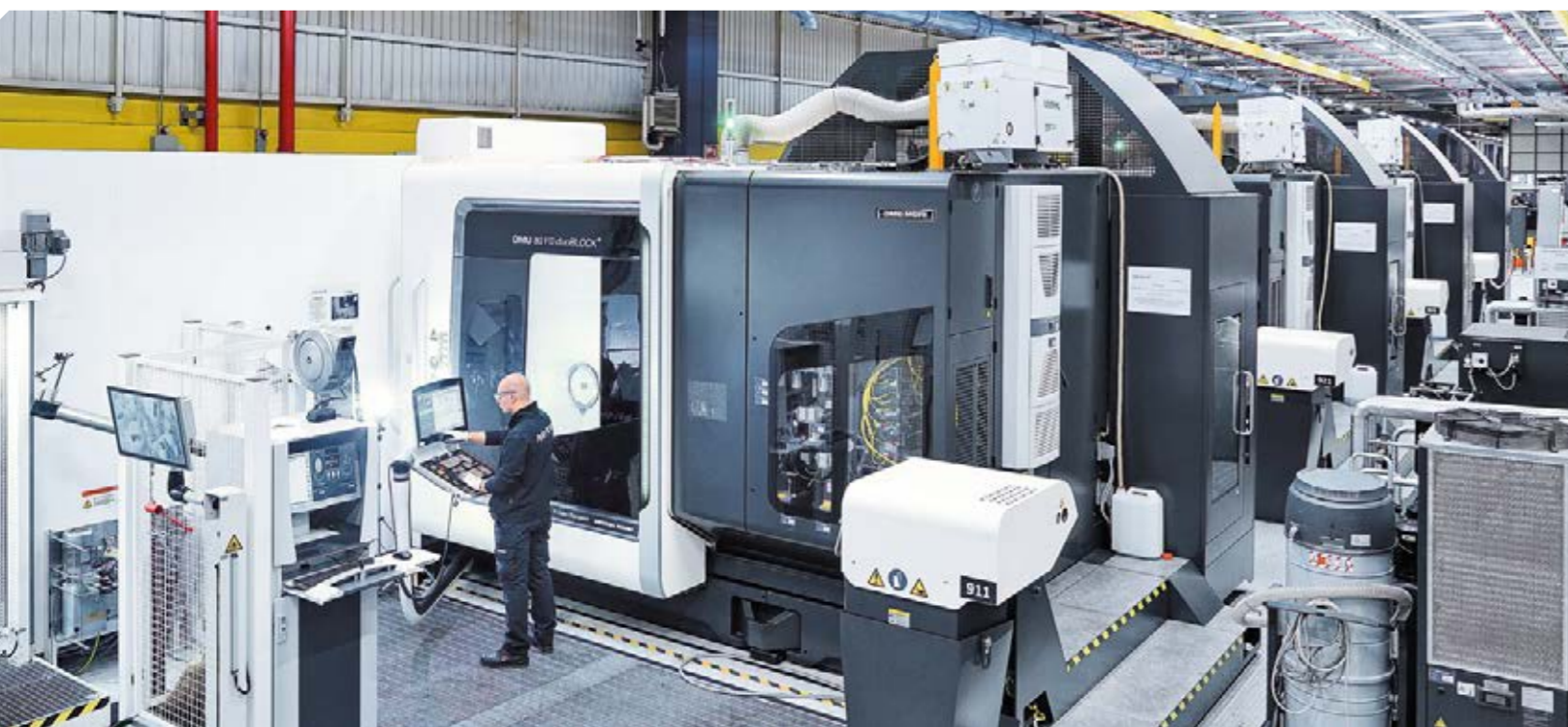
Ügyfélspecifikus automatizálás: Négy automatizált DMU 80 FD duoBLOCK, amely egy paletta-tároló rendszerhez kapcsolódik.
