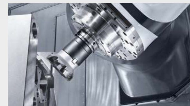
speedMASTER főorsó 20.000 fordulat/perc sebességgel és 130 Nm | 35 kW (40% DC) teljesítménnyel.
