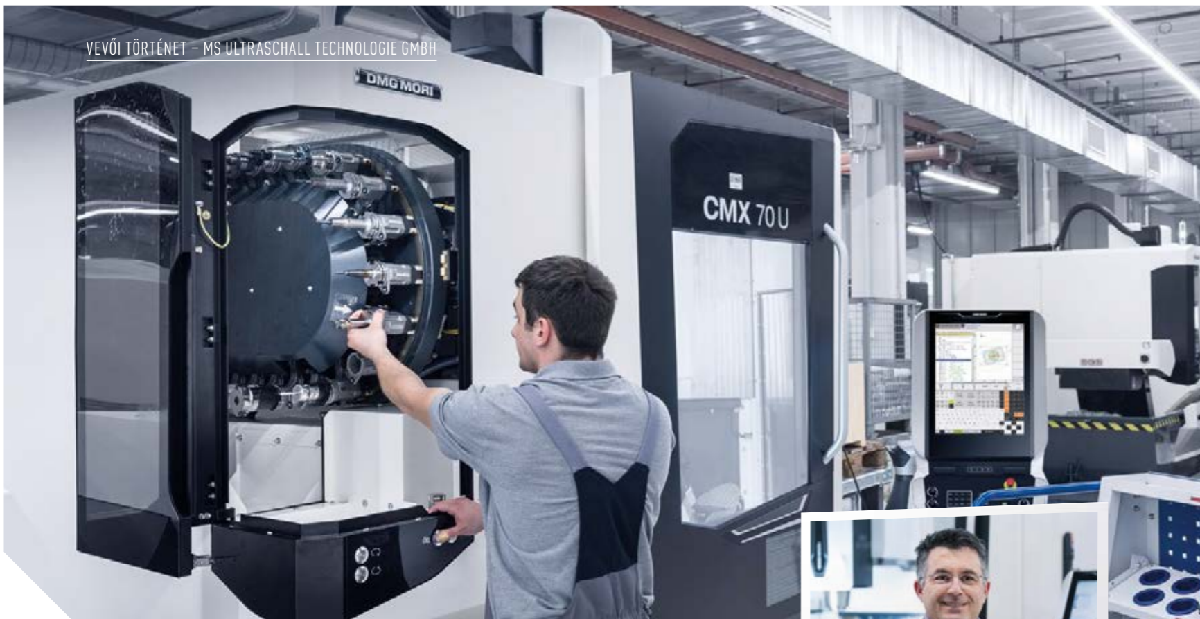
Beállítás megmunkálás közben, külön hozzáférhető kerék számszámjár révén egy CMX 70 U-n.
