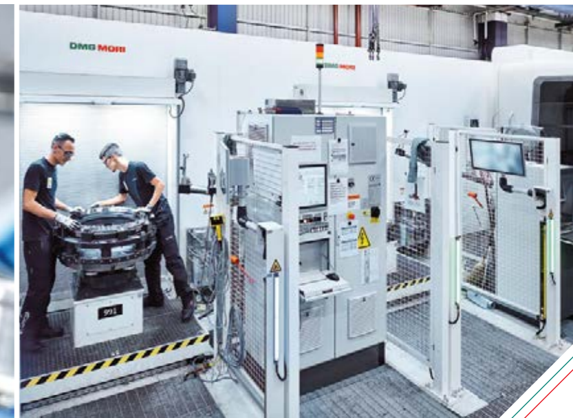
Palettázó állomás a négy DMU 80 FD duoBLOCK-ból álló gyártósornál.
