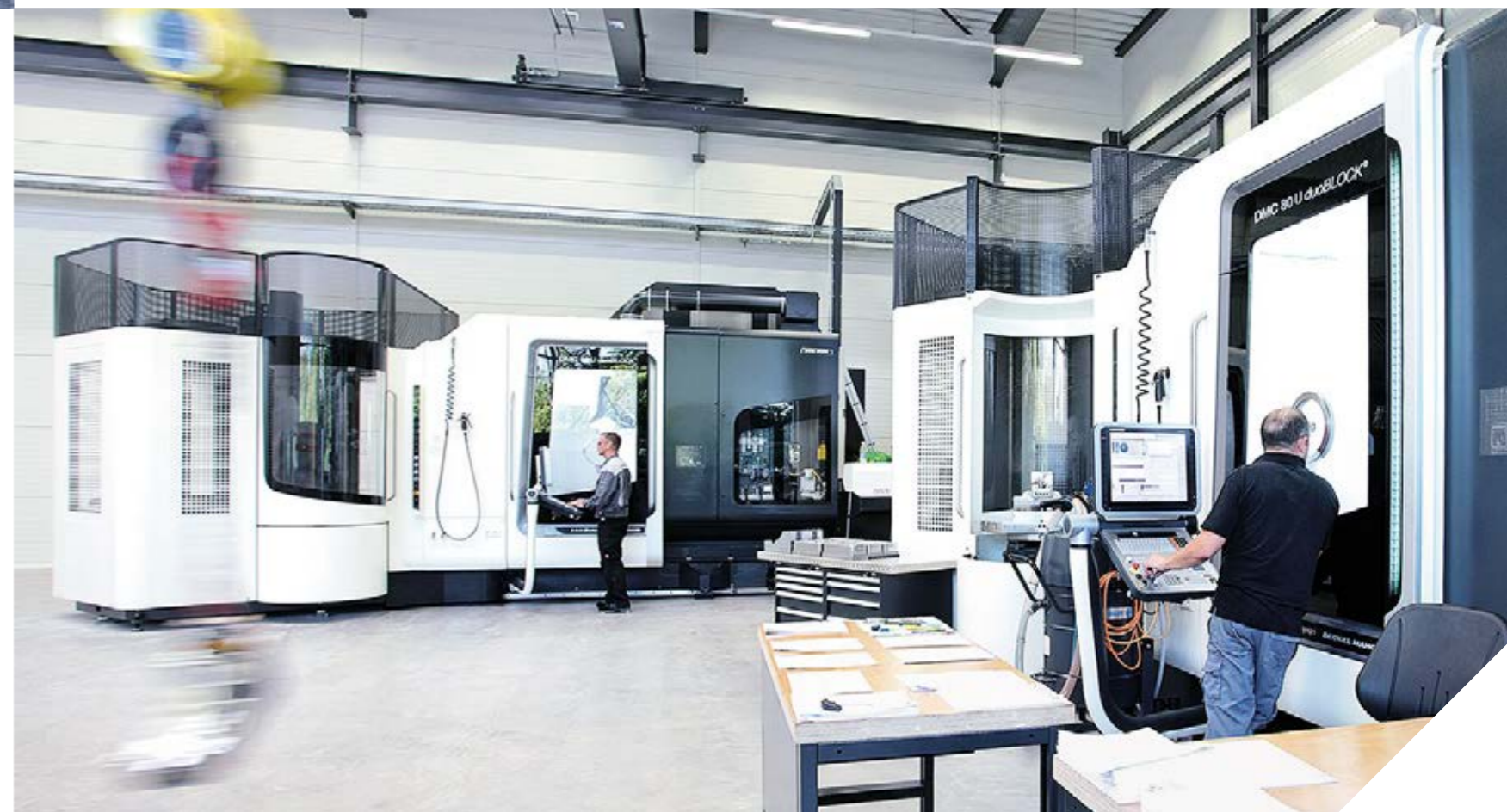
Két RS 12 tizenkét-palettás forgó tárhellyel felszerelve a két DMC 80 U duoBLOCK megállás nélkül dolgozik.
