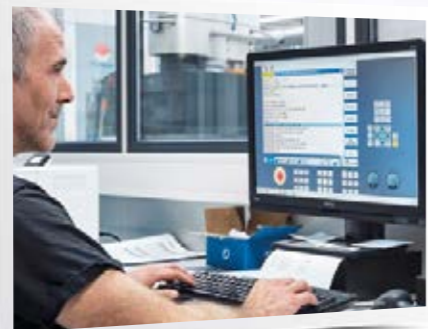
Az egyedi megrendeléseket az irodában, PC-n programozzák; a gyártási asszisztensek töltik a gyártócellára a betöltőállomásokon.
