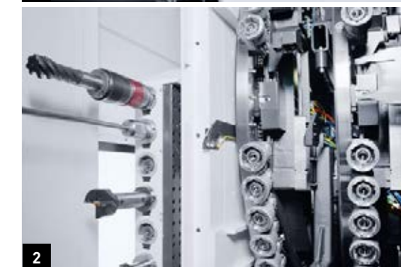
1. Tökéletes ergonómia: Állítható magasságú szerszámbeöltő állomás a 8 darabos szerszámkészlethez, amelyek mindegyike 30 kg tömegű szerszám azonosítással. 2. A szerszámok automatikus cseréje a rakodóállomástól a dobtárig.
