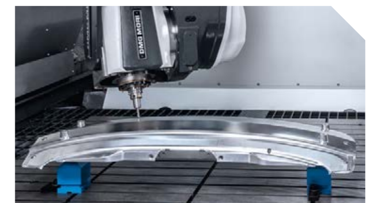
Szerszám- és formagyártás 5-tengelyes szimultán megmunkálás alumínium öntöbetétén
