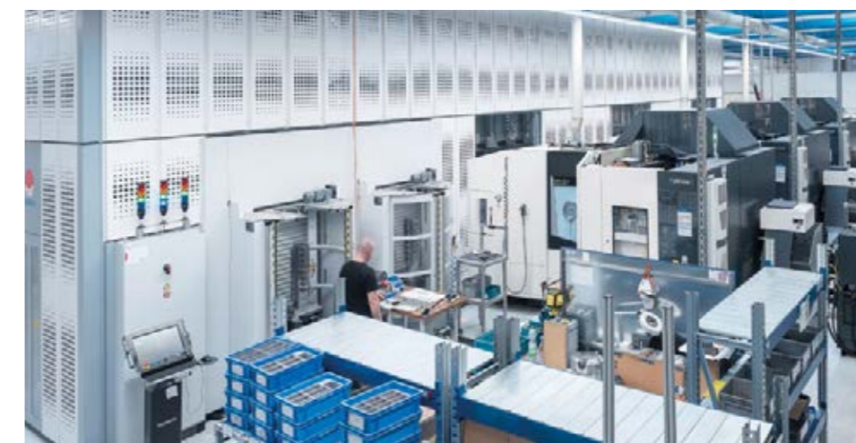
Az eddig telepített automatizációs rendszerek közül a legnagyobb 3 db DMC 60 H szerszámgépet foglal magába, mindegyik 5-kerekű szerszámtárral rendelkezik, 303 db szerszámkapacitással.
